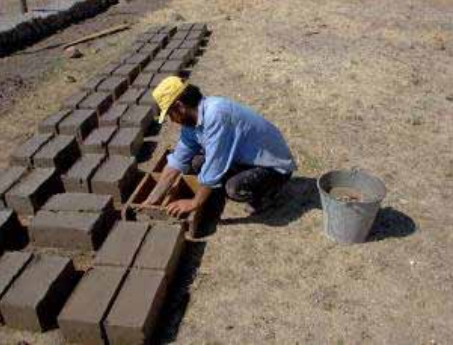
Kerpiç tahta kalıplara dökülerek güneşte kurutuluyor.
