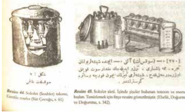
Sokslet (Soxhlet) takımı ve aleti; Nil Sarı, 2016, s. 45.
