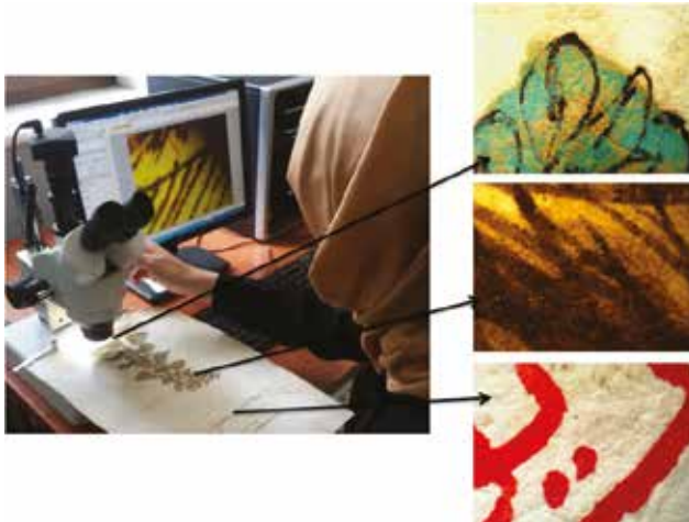
Şekil 40 – Stereo mikroskop altında kâğıt, boyar madde ve mürekkebin incelenmesi
