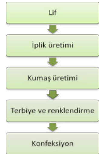
Şekil 9. Klasik tekstil ürünün standart üretim aşamaları
